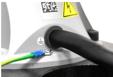
Afbeelding 30: De aardingsdraad bevestigen aan de robot
