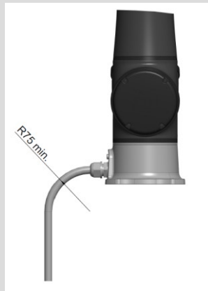
Afbeelding 76: De robot en de bedieningsdoos aansluiten
