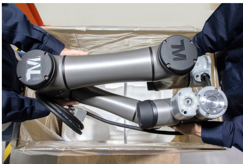
Afbeelding 75: De robotarm bewegen (2/2)
