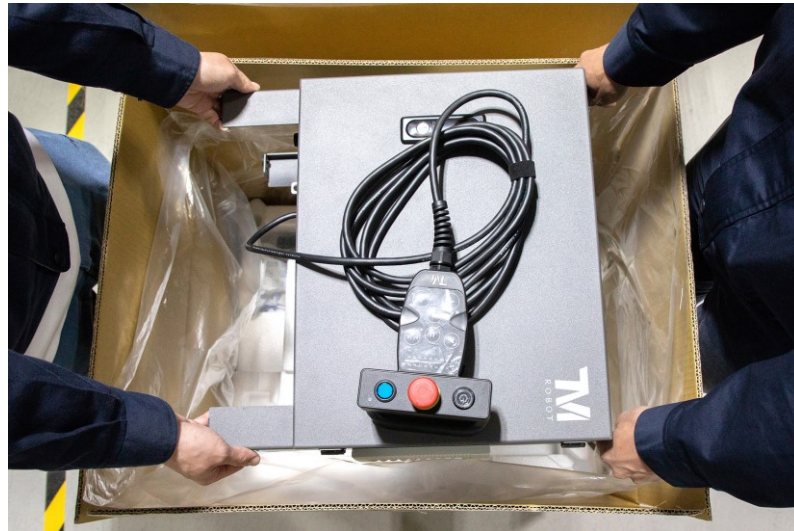
Afbeelding 73: De bedieningsdoos verplaatsen (2/2)
