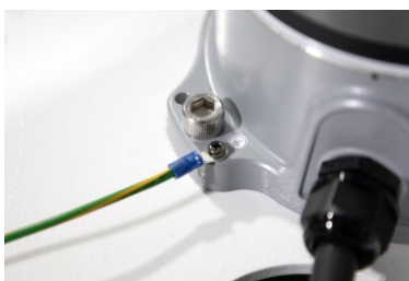
Afbeelding 17: Aardingspositie voor de robot
